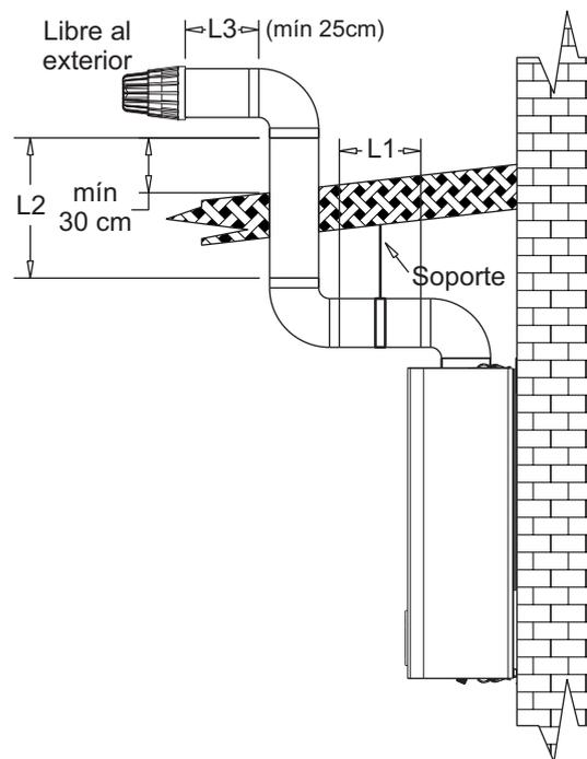
**Nota:** Obsérvese que en los ejemplos dados se determinan distancias mínimas que deben respetarse en cualquier otro tipo de configuración para asegurar la buena evacuación de los productos de combustión.
