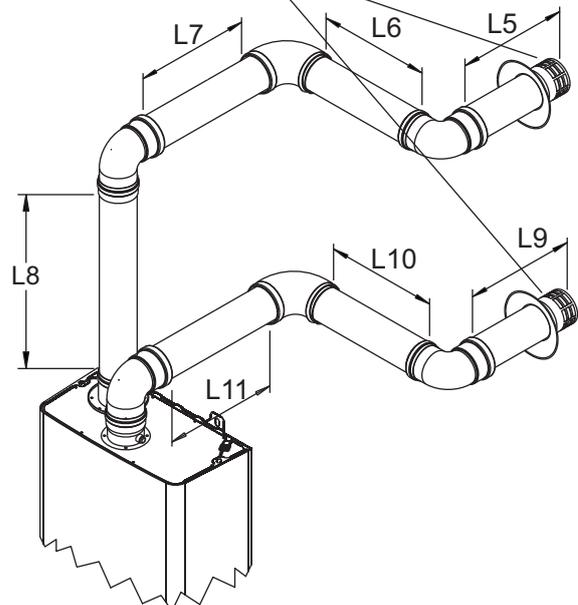
**Nota:** Obsérvese que en los ejemplos dados se determinan distancias mínimas que deben respetarse en cualquier otro tipo de configuración para asegurar la buena evacuación de los productos de combustión.
