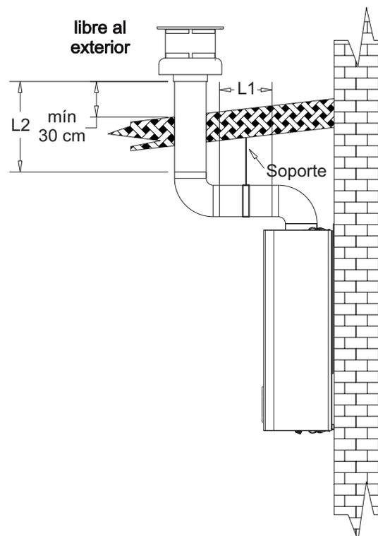
**Nota:** Obsérvese que en los ejemplos dados se determinan distancias mínimas que deben respetarse en cualquier otro tipo de configuración para asegurar la buena evacuación de los productos de combustión.
